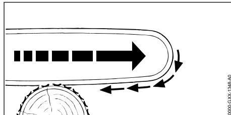
Hvis det arbeides med undersiden av styreskinnen, trekkes motorsagen bort fra brukeren.
