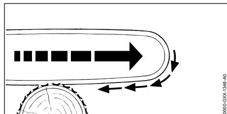
При пилении нижней стороной направляющей шины мотопила может быть затянута в сторону.
