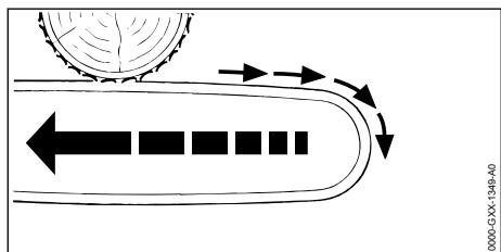
Se o trabalho for efetuado com a parte superior da guia, a motosserra é empurrada no sentido do utilizador.
