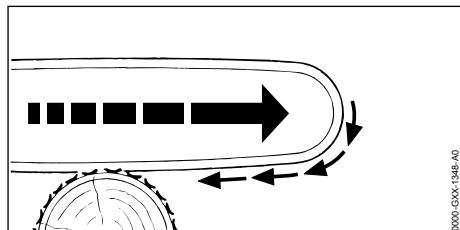
Atunci când se lucrează cu partea inferioară a șinei portlanț, motoferăstrăul este tras departe de utilizator.
