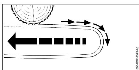
Atunci când se lucrează cu partea superioară a șinei portlanț, motoferăstrăul este împins pe direcția utilizatorului.
