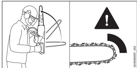
Zpětný ráz může vzniknout z níže uvedených příčin:
