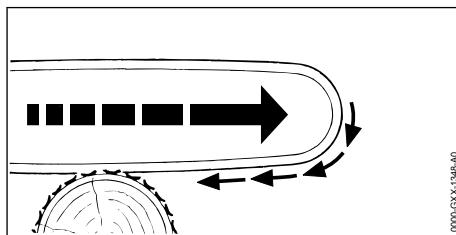
Pokud se pracuje se spodní větví vodící lišty, je motorová pila tažená pryč od uživatele.
