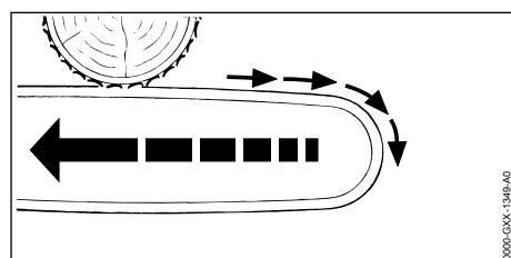
Wenn mit der Oberseite der Führungsschiene gearbeitet wird, wird die Motorsäge in Richtung des Benutzers gestoßen.
