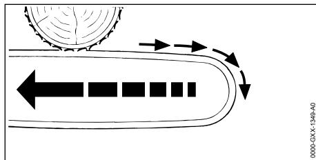
При пилении верхней стороной направляющей шины мотопилы может быть отброшена в направлении пользователя.
