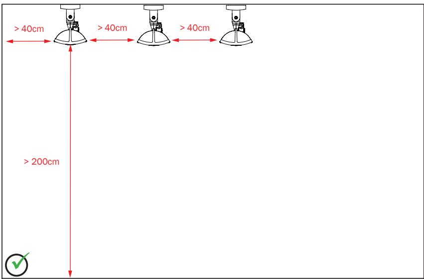
HEATSCOPE® Carbon-Heizstrahler wurden für den privaten und gewerblichen Einsatz für eine universelle Wand- und Deckenmontage konzipiert. Sie erzeugen Wärme innerhalb von wenigen Sekunden dort, wo sie benötigt wird. Der Infrarot-Strahler ermöglicht es, die Wärme im Idealfall zielgerichtet über eine Distanz von bis zu 3 Metern zu transportieren.
