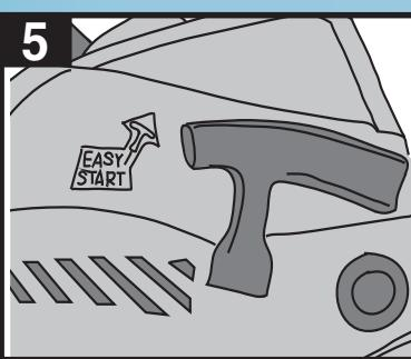
**IT:** Se la motosega è dotata di EASY-START, tirare la manopola di avviamento in modo costante, senza strappi vigorosi. L'avviamento avviene nell'ultimo tratto di corsa.
