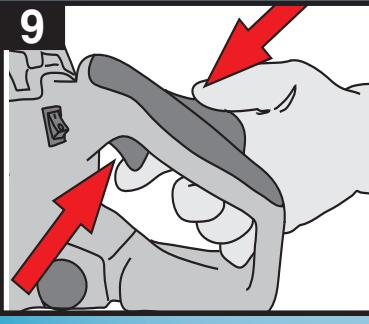
**IT:** Lasciare girare il motore per 10 - 15 secondi a pieni giri, quindi premere verso il basso la leva di bloccaggio acceleratore e tirare su il grilletto acceleratore per riportare il motore al minimo.
